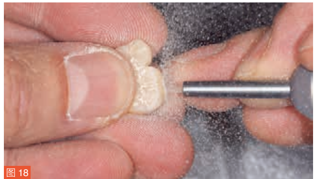
图 18: 为染色烧结做准备: 根据制造商说明进行喷砂。
